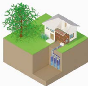
Pompe à chaleur sur corbeilles géothermiques
